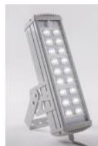
Промышленный светильник Радуга-045-СУБ-02-320-66 Мощность, Вт: не более 45 Степень защиты, IP: 66 Световой поток, лм: 4550 Гарантия, лет: 3-5
