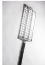
Уличный светильник Радуга-180-СУБ-02-316-66 Мощность, Вт: не более 180 Степень защиты, IP: 66 Световой поток, лм: 18000 Гарантия, лет: 3-5
